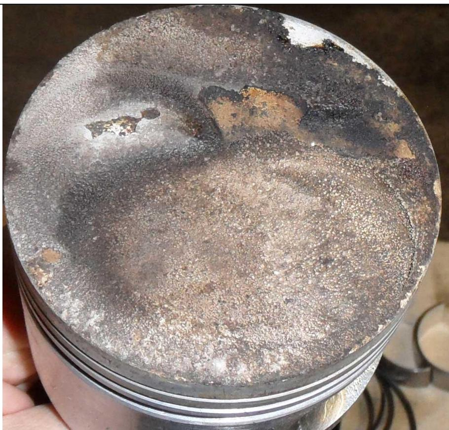
Рис. П-5-3. Общий вид огневой поверхности поршней после испытаний на нагарообразование. Базовый бензин с топливной компонентой E3000 (0,30% vol) после испытаний R200.
