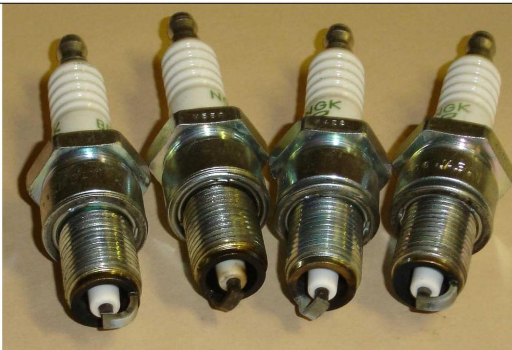
Рис. П-3-1. Общий вид свечей зажигания после испытаний на нагарообразование. Базовый бензин с топливной компонентой E3000 (0,30% vol).
