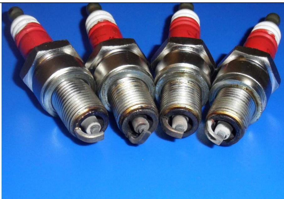
Рис. П-1-1. Общий вид свечей зажигания после испытаний на нагарообразование. Базовый бензин.
