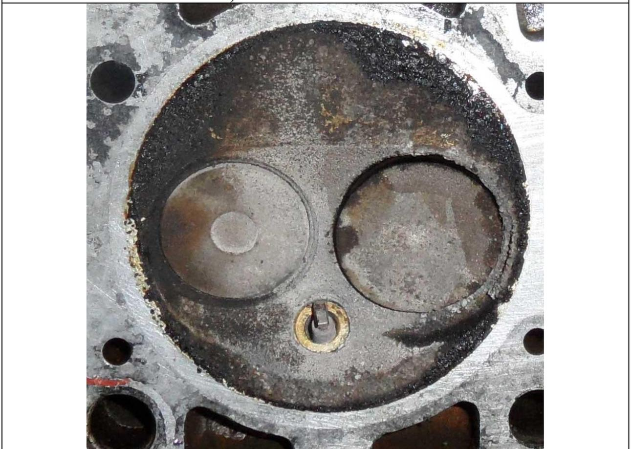
Рис. П-5-2. Общий вид огневой поверхности головки блока цилиндров после испытаний на нагарообразование. Базовый бензин с топливной компонентой E3000 (0,30% vol) после испытаний R200.
