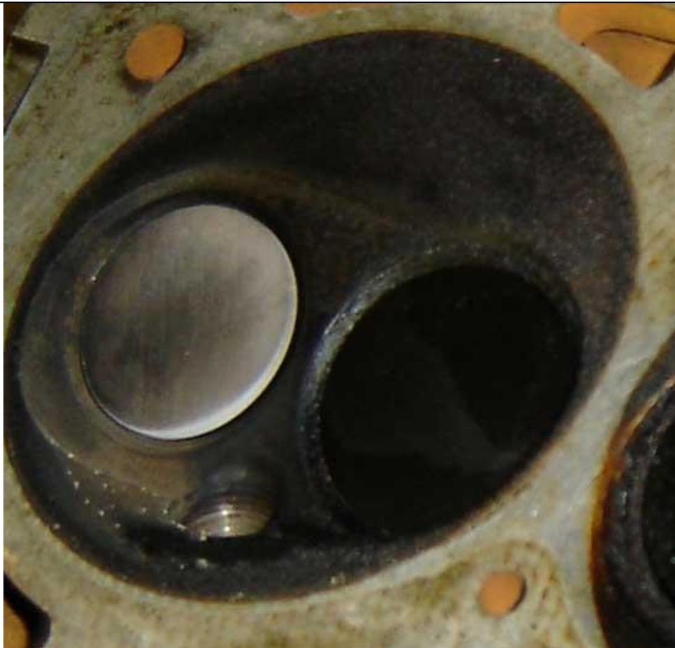
Рис. П-2-2. Общий вид огневой поверхности головки блока цилиндров после испытаний на нагарообразование. Базовый бензин с топливной компонентой E3000 (0,15% vol).
