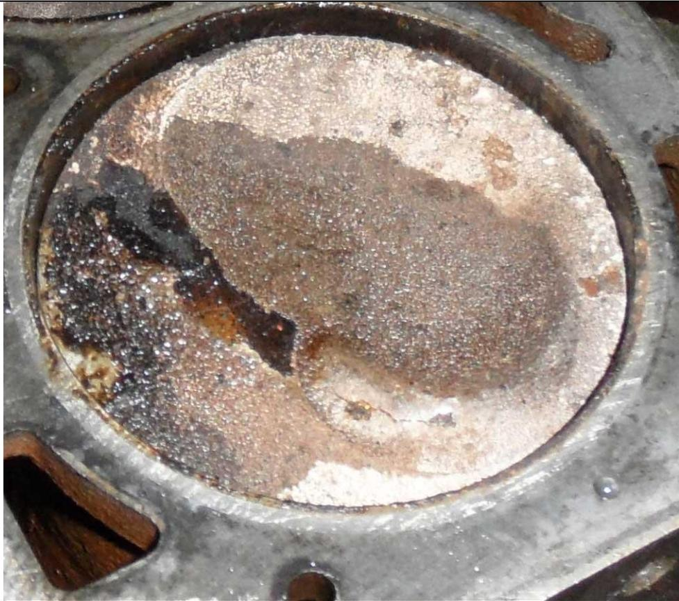
Рис. П-4-3. Общий вид огневой поверхности поршней после испытаний на нагарообразование. Базовый бензин с октаноповышающей присадкой R200 (1,0% vol).
