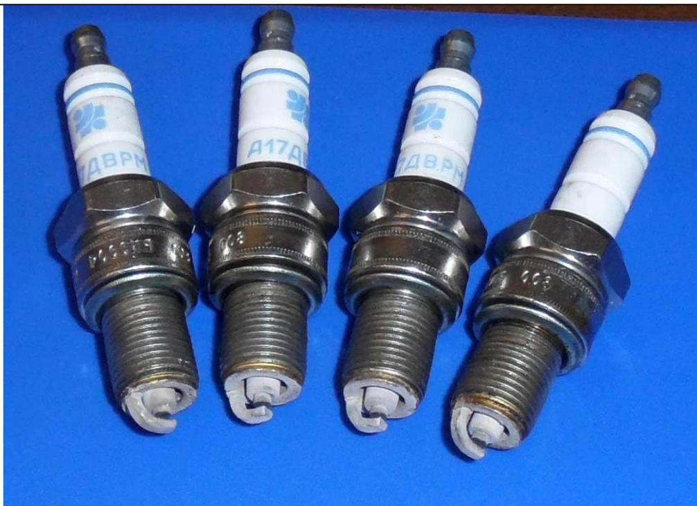
Рис. П-4-1. Общий вид свечей зажигания после испытаний на нагарообразование. Базовый бензин с октаноповышающей присадкой R200 (1,0% vol).
