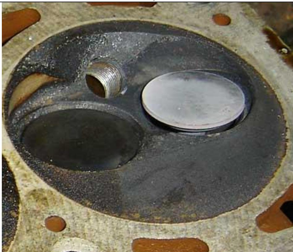
Рис. П-3-2. Общий вид огневой поверхности головки блока цилиндров после испытаний на нагарообразование. Базовый бензин с топливной компонентой E3000 (0,30% vol).
