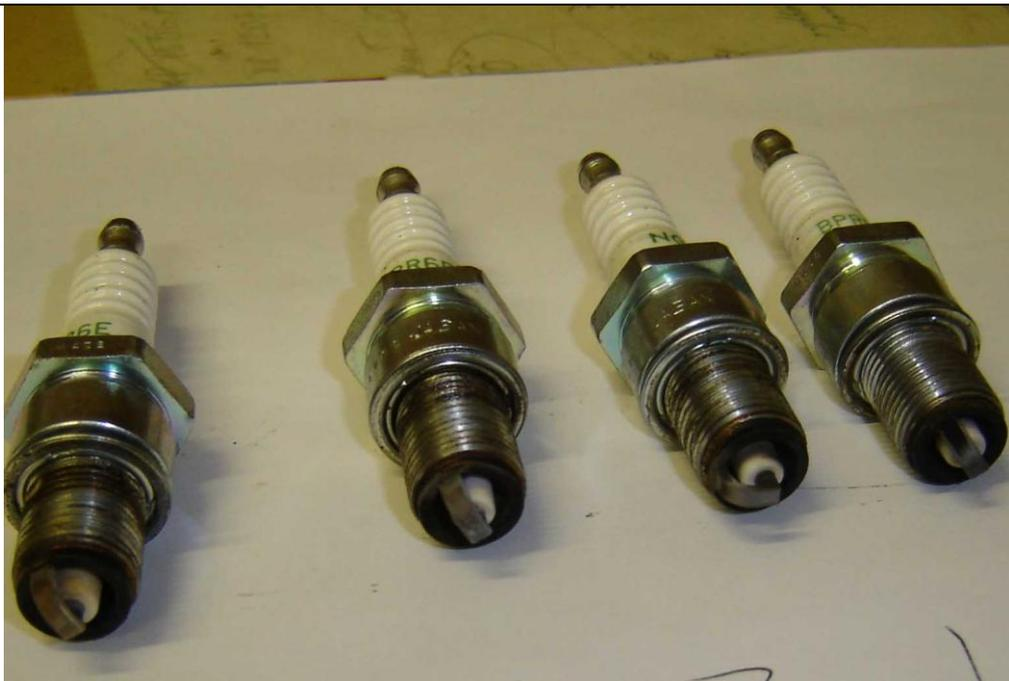
Рис. П-2-1. Общий вид свечей зажигания после испытаний на нагарообразование. Базовый бензин с топливной компонентой E3000 (0,15% vol).
