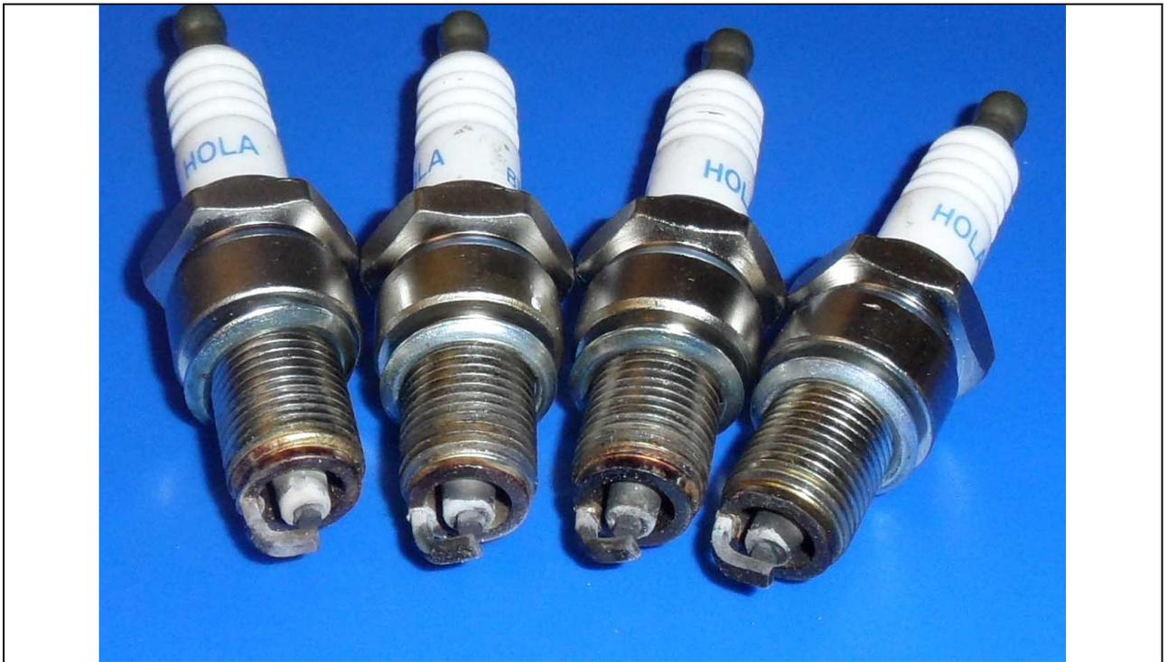
Рис. П-5-1. Общий вид свечей зажигания после испытаний на нагарообразование. Базовый бензин с топливной компонентой E3000 (0,30% vol) после испытаний R200.
