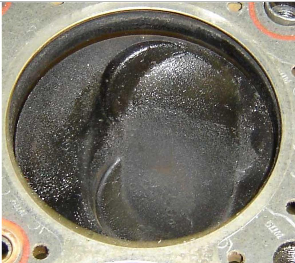
Рис. П-1-3. Общий вид огневой поверхности поршней после испытаний на нагарообразование. Базовый бензин.
